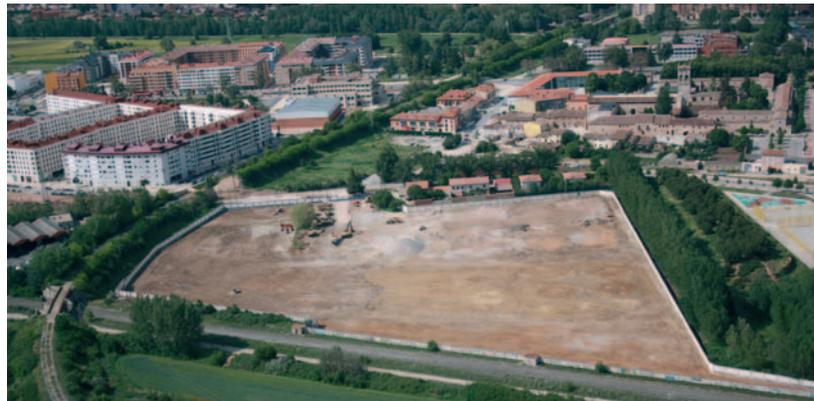
CLH ha concluido el desmantelamiento de los tanques de la antigua planta de almacenamiento situada en la zona de Hospital del Rey (Burgos), tras haber desmontado los tanques, tuberías y otros equipos, además de demoler los edificios que componían esta instalación. En total se han reciclado cerca 11.000 metros cúbicos de escombros y cerca de 2.700 toneladas de metales
